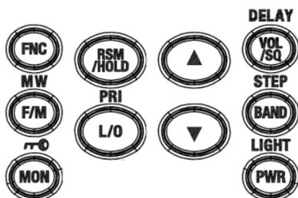
Die Tasten Ihres Scanners sind teilweise doppelt mit verschiedenen Funktionen belegt. Diese Funktionen finden Sie aufgedruckt auf der jeweiligen Taste bzw. über der Taste.
